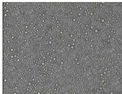
Рис. 8. Структура эмульсии, выработанной с продолжительностью 120 сек, Ув 40
