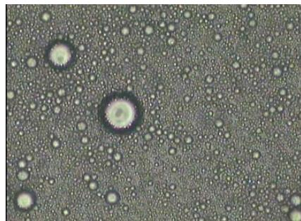
Рис. 9. Структура эмульсии, выработанной с продолжительностью 150 сек, Ув 40
