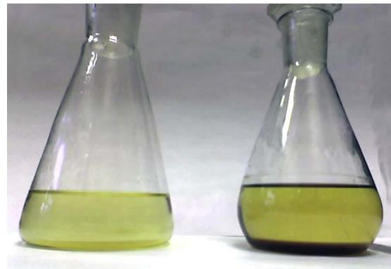
Рис. 2. Метиловые эфиры рапсового масла (слева) и неочищенный биодизель на основе метиловых эфиров жиросодержащего сырья животного происхождения (справа)
